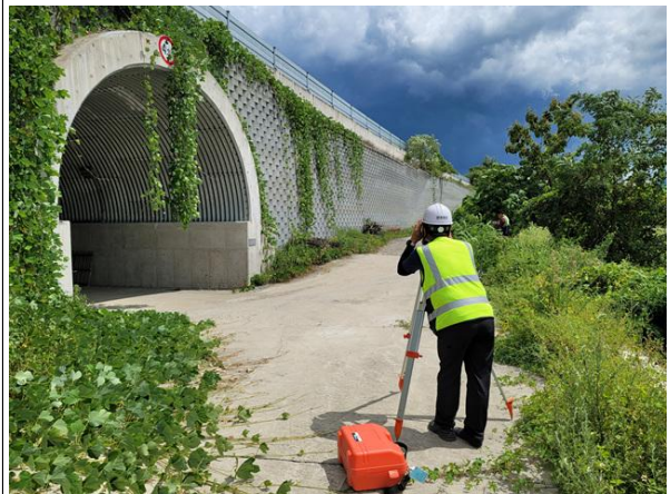
광파기를 이용한 경사도 측정
